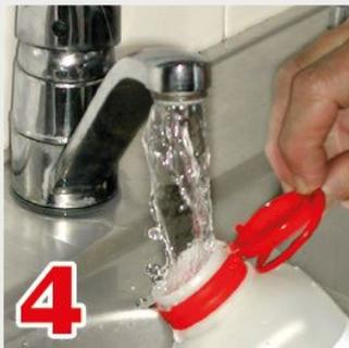
**4** Réaliser le prélèvement sans arrêter l'écoulement de l'eau s'il y a plusieurs flacons.
